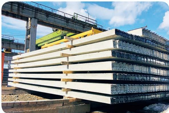
Стойки железобетонные вибрированные для опор ВЛ 0,4...10кВ с применением арматуры класса Вр-II
