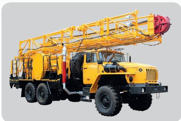
Агрегат для ремонта скважин А5-40Т1
