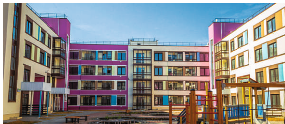
WanderBlok (стеновые панели из крупноформатных керамических кирпичей)
