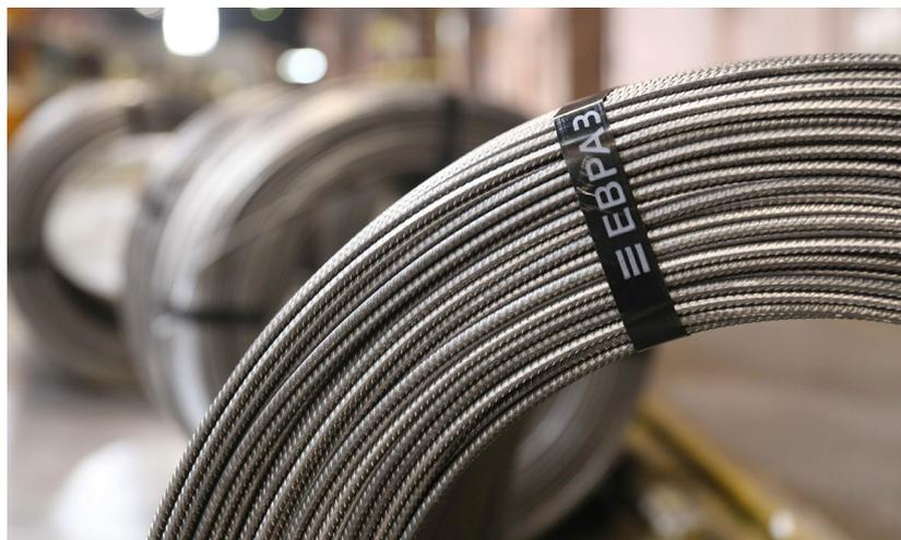
Прокат арматурный холоднодеформированный периодического профиля класса В500С диаметрами 5-10 мм в бунтах применяется для изготовления сварных сеток в железобетонных конструкциях, сеток противотоковых для огневой защиты железобетона, сеток штукатурных для крепления каменной и кирпичной кладки.
