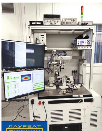
Комплекс предназначен для выполнения оптической стыковки при сборке волоконных, фотонных и оптоэлектронных изделий. Юстировка компонентов осуществляется по оптическим и электрическим сигналам. Автоматическое нанесение полимера производится в точки с заданными координатами. Весь сборочный процесс автоматизирован.
