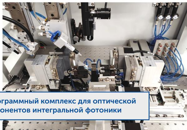
Аппаратно-программный комплекс для оптической стыковки компонентов интегральной фотоники
